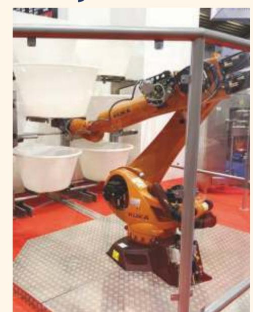
**SIGMA**, un nume binecunoscut și în România, a propus o soluție care s-a arătat a fi foarte interesantă, fiind apreciată și de câteva companii mari din România. Un braț robot care preia cuvele cu aluat, depozitându-le pe un rastel special, pentru repaos. Soluția tehnică este deosebit de atractivă pentru firmele cu proces de producție în trei faze de lucru sau pentru producătorii de panettone, în ambele cazuri procesul de repaos al aluatelor fiind esențial și de lungă durată.
